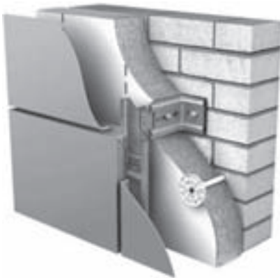
Рис. 6.5.3 Вентильована система фасаду з утепленням з зовні.
