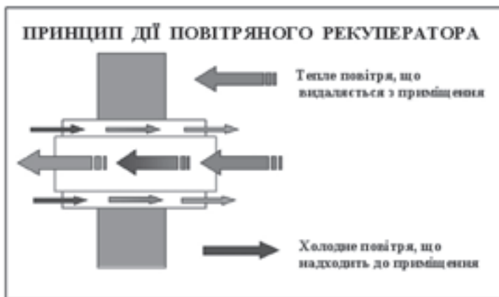
Рис. 6.5.16 Принцип дії рекуператора.
